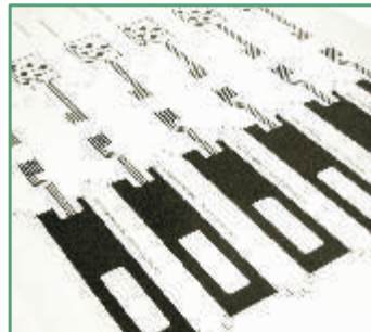
Realizzazione della parte attiva della tastiera (circuito elettrico flessibile) con paste conduttive Realization keyboard's active part (flexible circuit) with pastes conductive basis in silver
